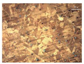
Lám. 2. Metalografía del brazalete PA13573 (CMV08-310-16) que muestra una estructura de trabajo de forja en frío con recocido final.
