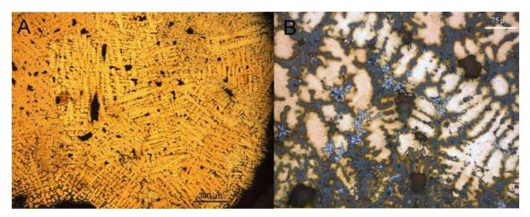
Lám. 4. Metalografías de los restos de fundición de El Calvari: A. PA20012 (CVM09-348-1) y B. PA13568 (CMV08-316-60) ambos con microestructura dendrítica de bruto de colada de enfriamiento muy rápido.
