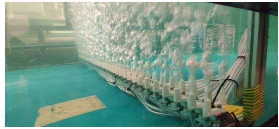
(D) Parametric bubble curtain under operation
