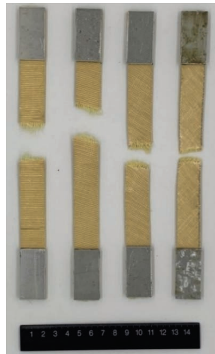
图 7 拉伸试验断裂样品图
