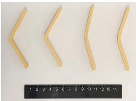
图 10 弯曲试验断裂样件图
