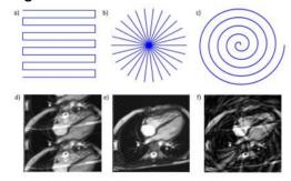
Efficient k-space trajectories; a) EPI, b) Radial, c) Spiral.
