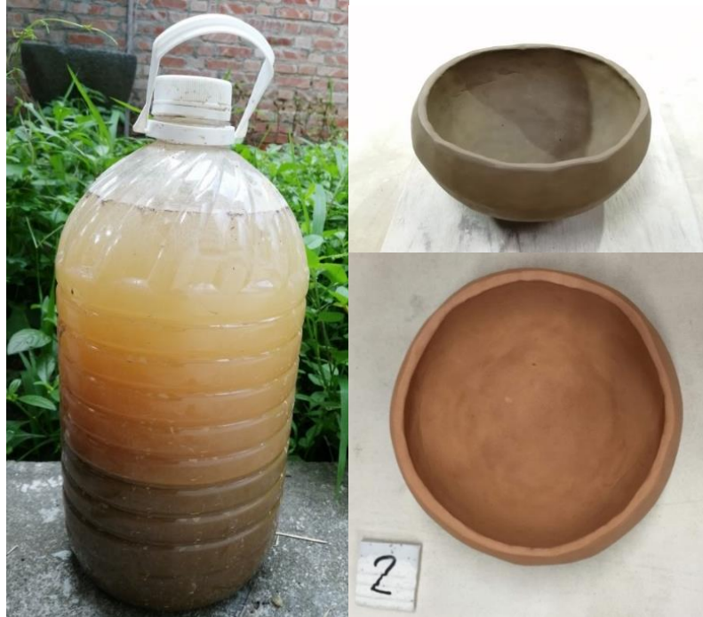
圖一 沉降法實驗與沉降陶土製成的陶鉢
