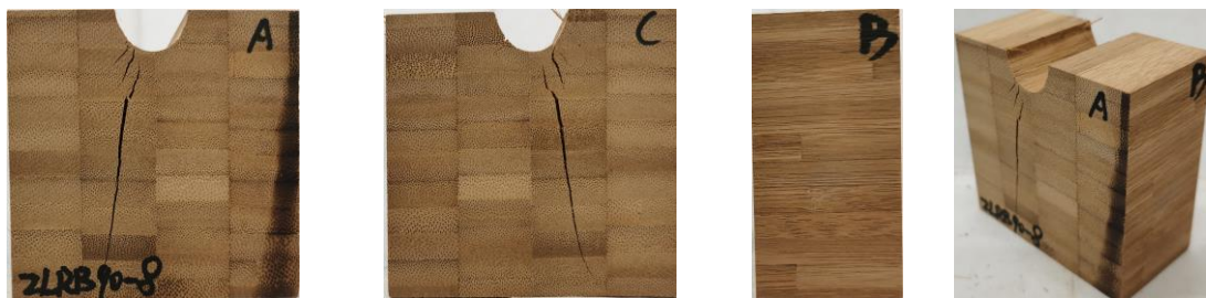
(d) Failure mode VIII
