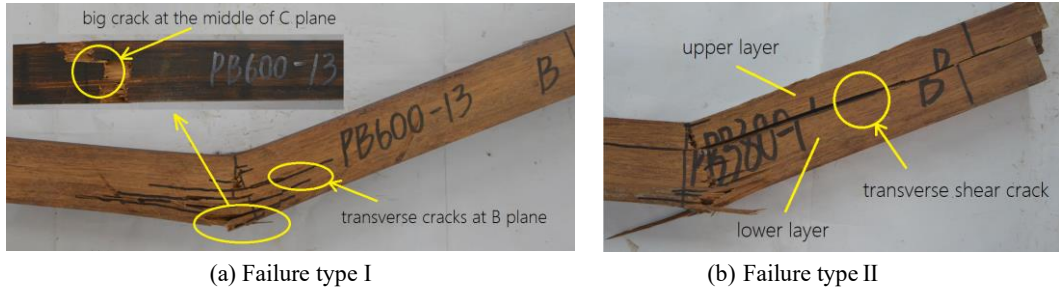
(a) Failure type I (b) Failure type II (c) PB600-13 (d) PB380-1
