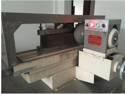
图 3 混凝土试块逐层磨削
