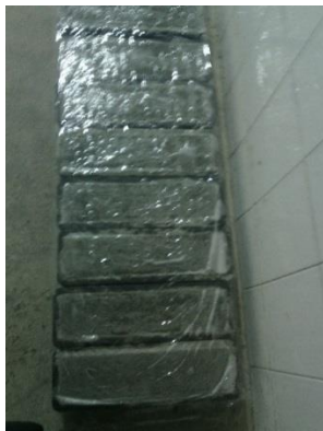
图 5 混凝土试块（70×70×280 mm）静置 24h
