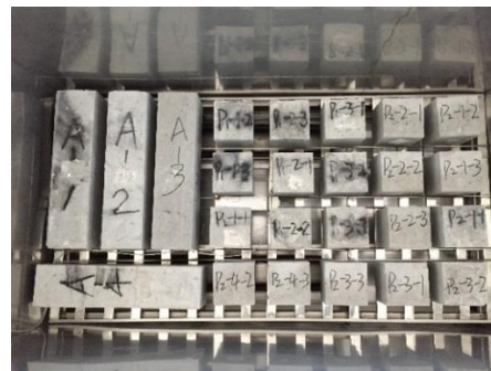
图 8 试验机内试块摆放
